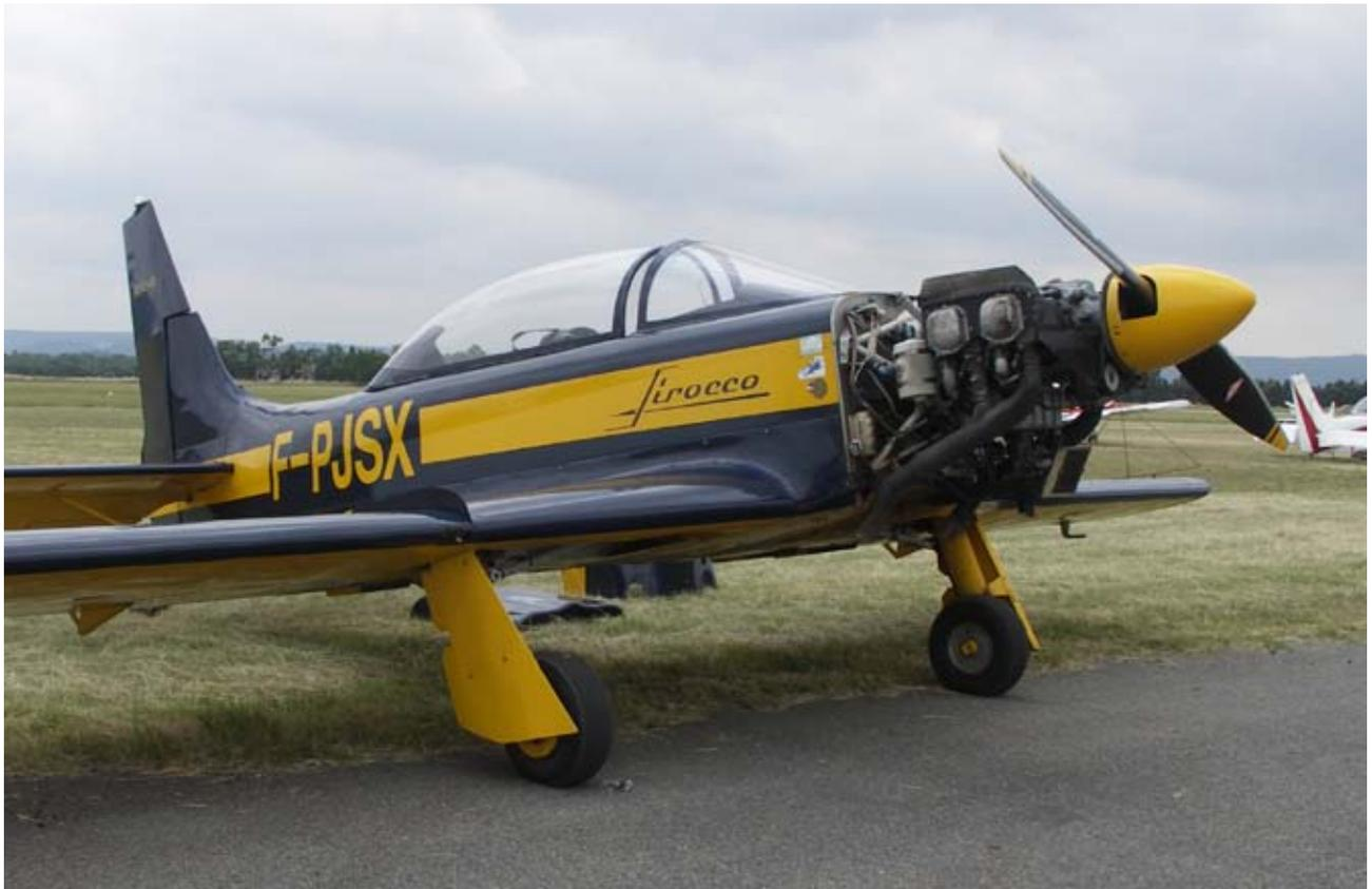
Vue avant droite décapotée d'un Sirocco MJ5-K2 (180 cv train rentrant).
