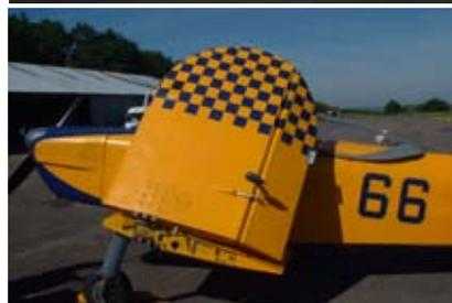
Aile repliable au gabarit routier
