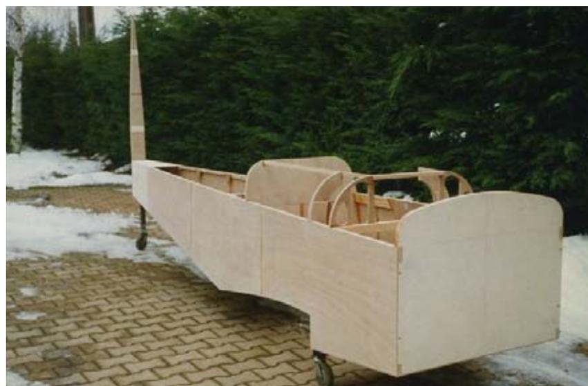
Fuselage avant réalisation du dos et de l'étambot
