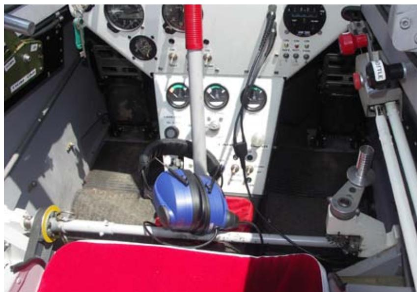
Barre de commande du train. Manivelle standard à droite, engrenage électrique à gauche
