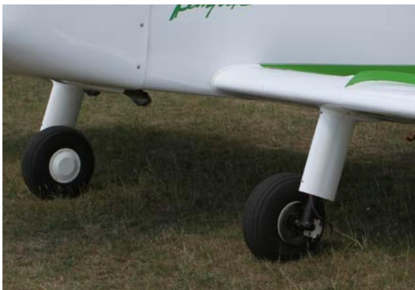
Vue du train fixe avec les carénages aérodynamiques des jambes. Les roues restent ici non carénées.
